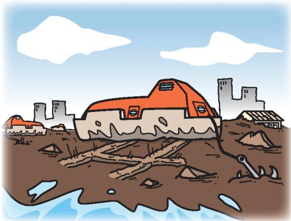
はじめに津波救命艇は内陸部に流され、津波が引くと着地して陸に残ります。海に流れそうなときは、おしりについている錨（アンカー）を降ろして、沖合に流れ出るのを抑えます。
